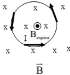
B aumenta atravesando la superficie de la bobina, luego el flujo magnético aumenta. La espira se opone produciendo un  $B_{\text{espira}}$  saliente. Por la regla de la mano derecha, la intensidad inducida tiene sentido antihorario.
