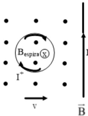
El hilo produce un campo magnético  $\vec{B}$  a su alrededor que atraviesa la superficie de la espira circular conforme la espira se acerca al hilo, el campo  $\vec{B}$  va aumentando, con lo cual el flujo magnético  $\phi$  que atraviesa la espira va aumentando.
